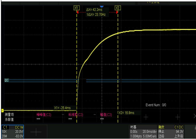
图(5) 25% ~ 50%负载动态波形 (28V)
