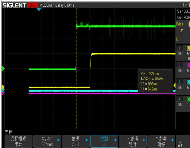
图(3) 电源开机波形 (28V)
