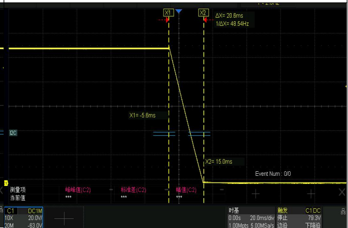
图(6) 50% ~ 75%负载动态波形 (28V)
